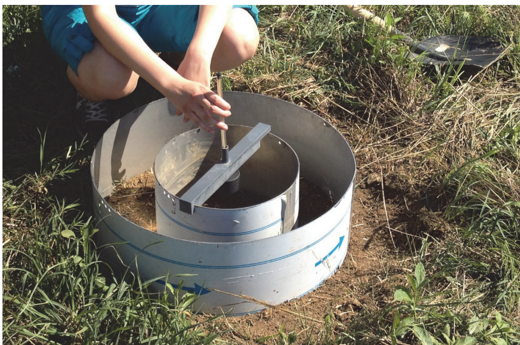
Obr. 2. Osadenie sústredných infiltračných valcov v dne odvodňovacieho kanála.
