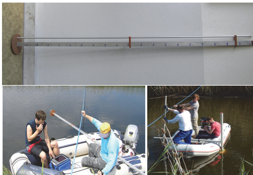
Obr. 2. Zariadenia na meranie hrúbky nánosov. Fig. 2. Measuring equipment.
