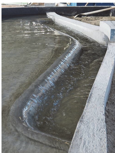
Obr. 3. Model bezpečnostného priepadu VN Ružín I a zameraná merná krivka. Fig.3. Model of the spillway of Ružín I Water Reservoir and measured rating curve.
