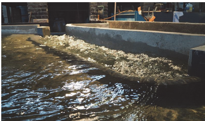
Obr. 4. Model bezpečnostného priepadu VN Ružín II a foto reálu.
