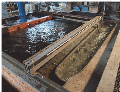
Obr. 1. Model bezpečnostného priepadu VN Veľká Domaša a jeho merná krivka.
