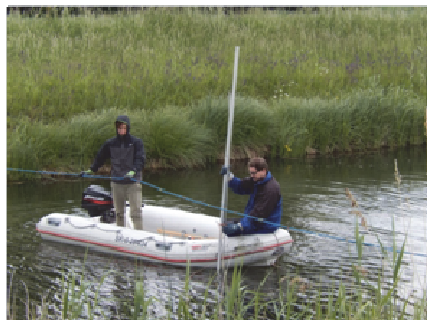
Obr. 3. Zariadenie na meranie hrúbky nánosu – Komárňanský kanál.
