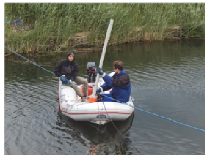
Obr. 3. Zariadenie na meranie hrúbky nánosu – Komárňanský kanál.
