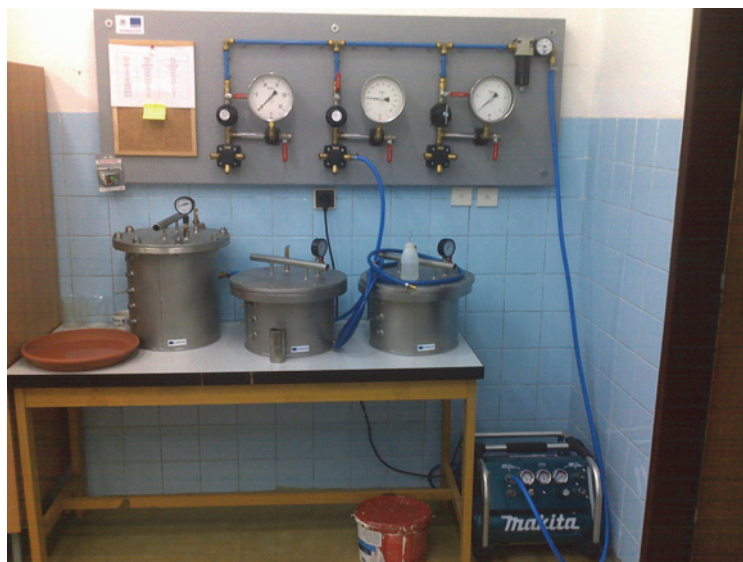
Obr. 2. Prístroj na meranie pF kriviek.
