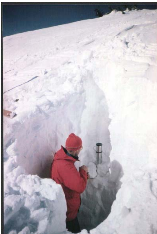
Obr. 1. Meranie vodnej hodnoty snehu v povodí Jaloveckého potoka.
