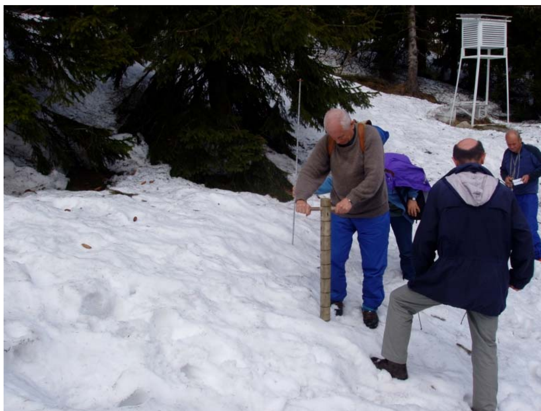
Obr. 1. Meranie vodnej hodnoty snehu pri Žiarskej chate snehomerom ČHMÚ. Fig. 1. Measurement of snow water equivalent at Žiarska chata with the equipment used at CHMI on 14 April 2005.
