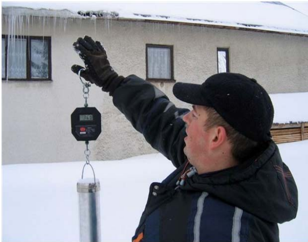
Obr. 2. Digitálna váha WMD 03 používaná na meranie vodnej hodnoty snehu na SHMÚ. Fig. 3. Digital scale WMD03 used to measure the snow water equivalent at SHMI.
