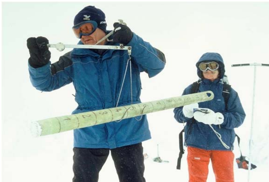
Obr. 2. R. Hancvencl pri merní vodnej hodnoty snehu snehovou váhou vlastnej výroby. Fig. 2. R. Hancvencl measuring the snow water equivalent with the sampler of his own desing.
