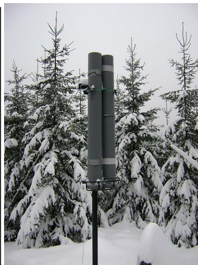
Obr. 2 Měsíční srážkové úhrny na stanici Bedřichov přehrada a Uhlířská za měsíce listopad-duben v letech 2006-2010 (vlevo), sněhový totalizátor (vpravo).
