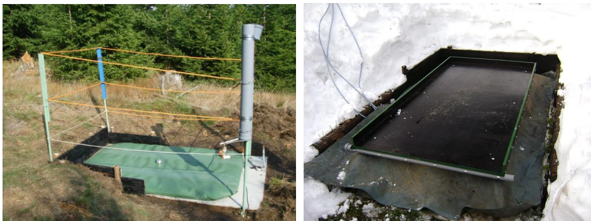
Obr. 4 Polštářový sněhoměr (vlevo) a váhový sněhoměr (vpravo) na lokalitě svahu Tomšovka, ČVUT.
