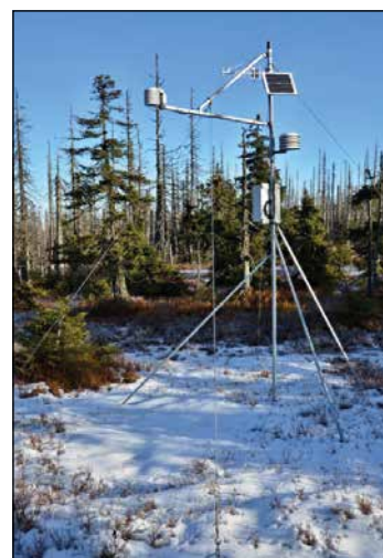
Obr. 1 Samostatně stojící automatická sněhoměrná stanice s ultrazvukovým čidlem na Plechém.
