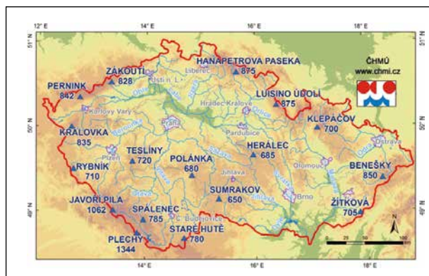
Obr. 1 Síť automatických sněhoměrných stanic (sněhoměrných polštářů) v ČHMÚ v roce 2016 (číslo za názvem stanice udává její nadmořskou výšku).
