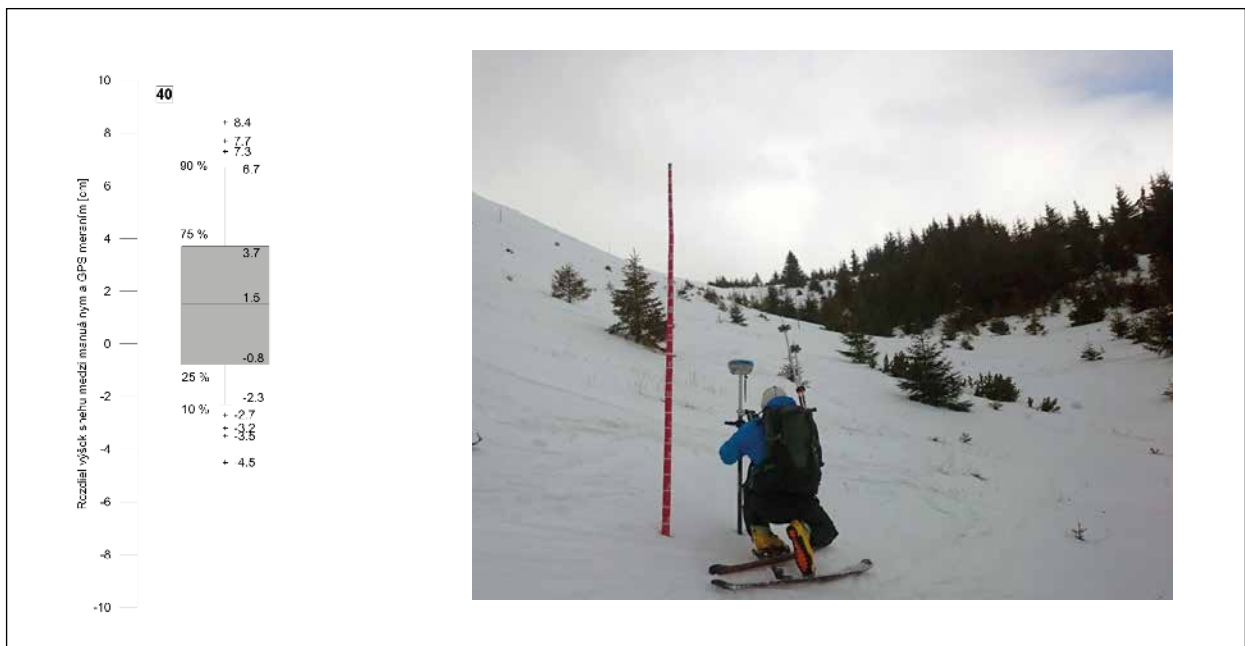
Obr. 8 Porovnanie manuálnych meraní výšky snehovej pokrývky s meraniami pomocou GPS.
